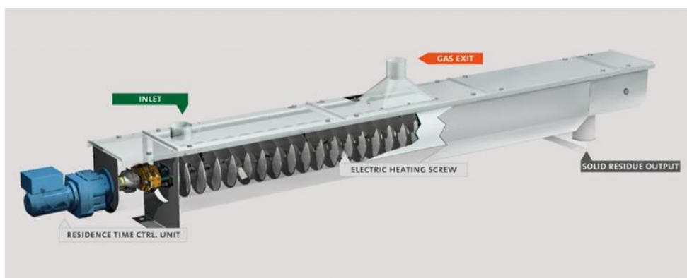
Figur 11. Prinsippskisse av ETIA-Biogreen's spirajoule pyrolysereaktor
