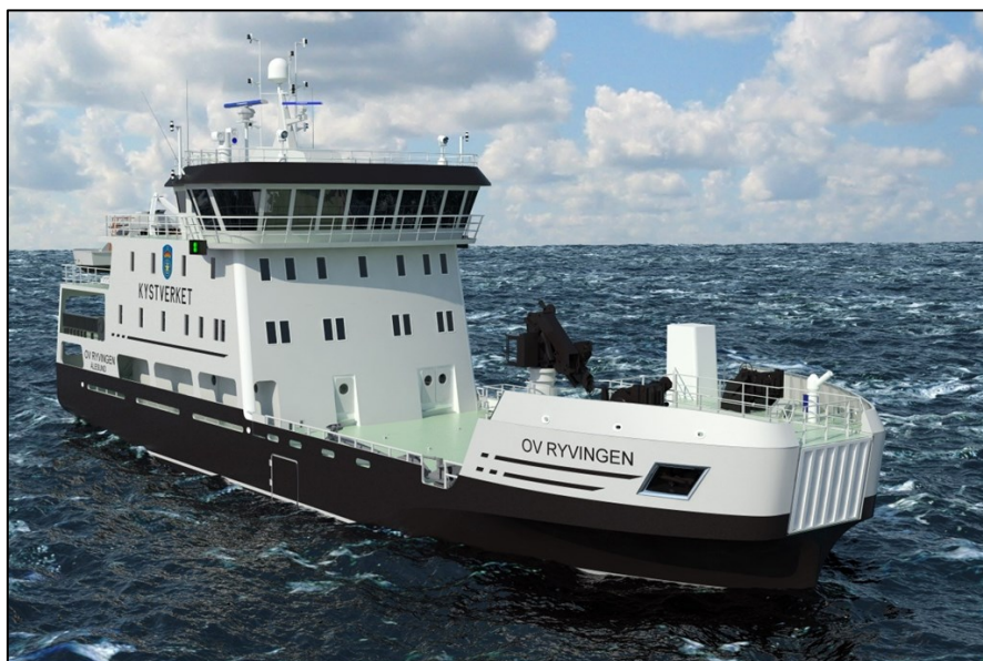
Figur 9-13: Kystverkets «OV Ryvingen» med levering høsten 2018 har en rekke innovative løsninger installert om bord, blant annet plugin-hybrid fremdriftssystem, «thermos» for dampbehov og elektriske dampkjeler (Teknisk Ukeblad, 2018).
