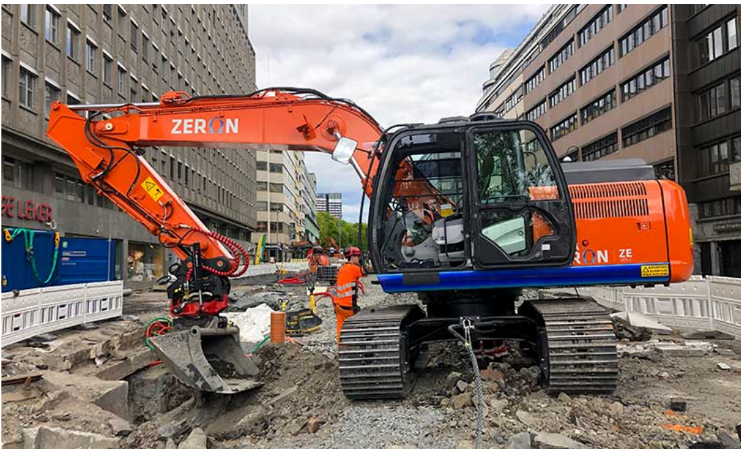
Figur 9 Oppgradert 16-tonns gravemaskin med kabelfestet flyttet til undervogn
